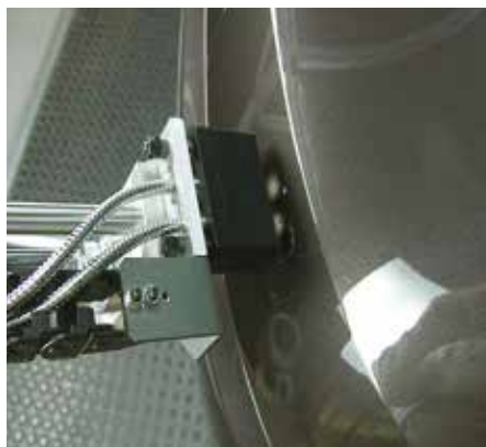
在汽车工业中，通过颜色传感器识别喷漆附件和车身部件的颜色一致性
