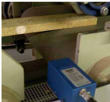
在木材加工行业，高速运输木材会使其表面发黑，通过颜色识别，可以预先对变色进行补偿处理
