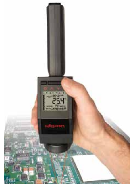
研发领域 针对集成电路上直径1mm部件的高精度红外温度测量
