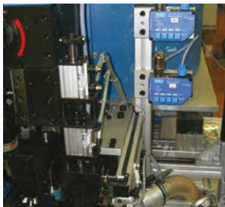
在生产过程中，自动检测电缆股线颜色，可以根据不同电缆型号，区分位置，数量和电缆股
